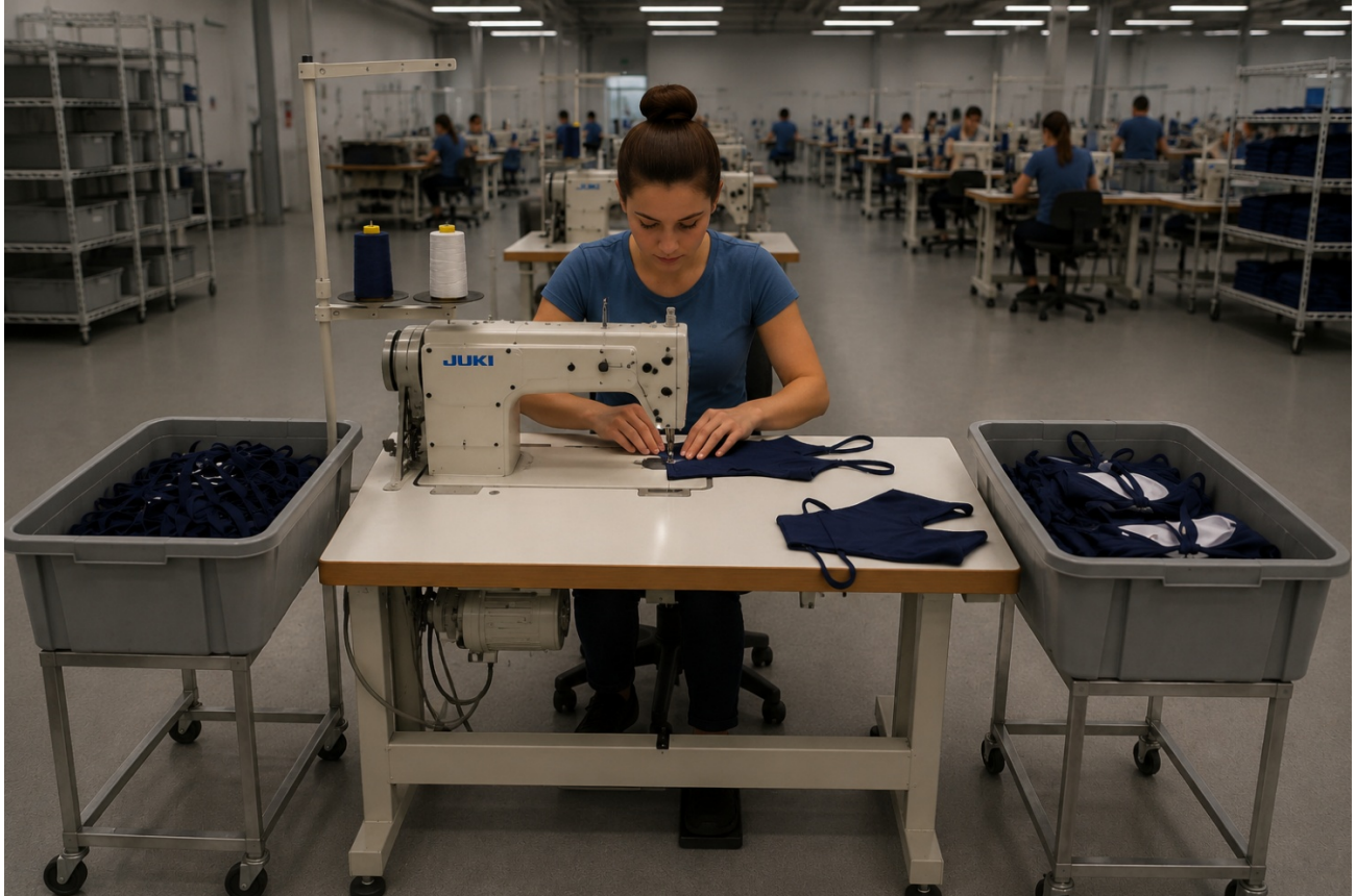
Slika 1. Polazna fotorealistična vizualizacija šivaće radne stanice: industrijski šivaći stroj, radna ploha, podesiva stolica, gazilo i posude za materijal lijevo/desno u pogonu
