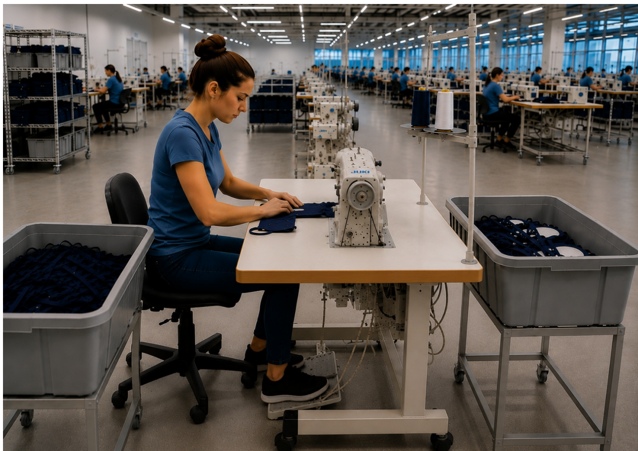
Slika 2. Fotorealistični prikaz položaja radnice, stola, stroja i gazila
